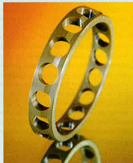
Kugellagerkäfige aus Torlon PAI verkräften Drehzahlen von bis zu 500 000 min -1 – eine klassische Anwendung für Hochleistungskunststoffe
